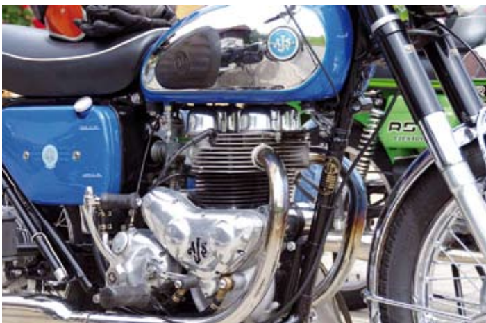
Vorne der schöne Twin-Motor, dahinter das bewährte AMC-Getriebe und am Rahmenrohr zu erkennen: die Luftpumpe.
