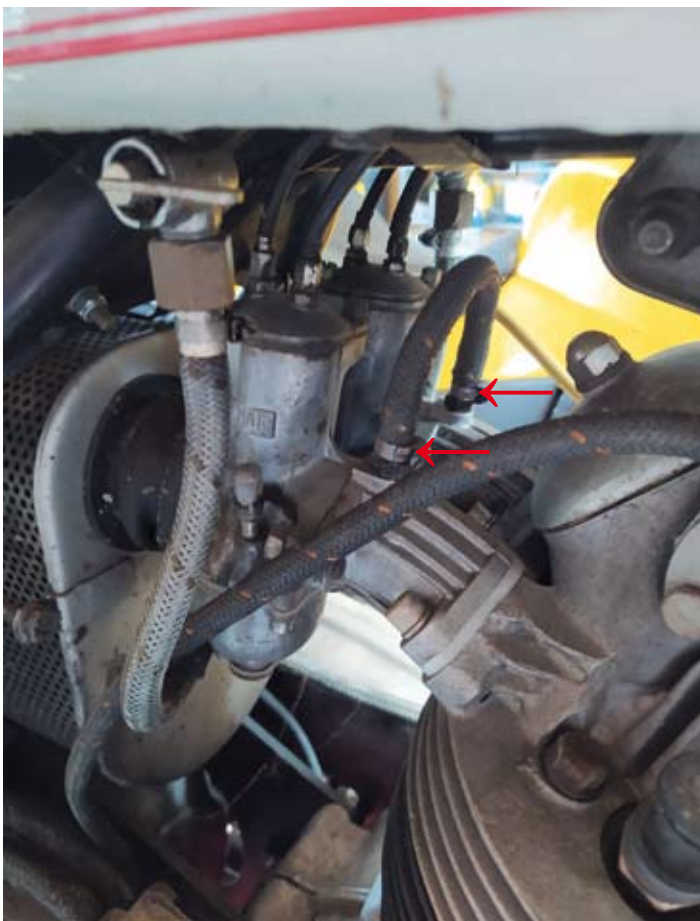
Vergaser und Ansaugstutzen einer 750er Commando. Anstelle des Interferenzrohr zwischen den Krümmern hat sie einen Verbindungsschlauch zwischen den Ansaugstutzen. Hier (Pfeile) können die Messschläuche angeschlossen werden
