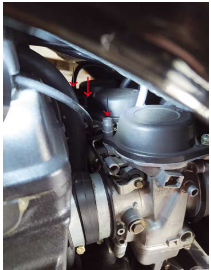
Mikuni Vergaser-Batterie einer Hinkley Trident. Die Anschlussstutzen für die Messschläuche befinden sich oben am Vergaserdeckel (Pfeile). Hier muss der Tank zum Anschließen der Messschläuche und zum Einstellen abgenommen werden.
