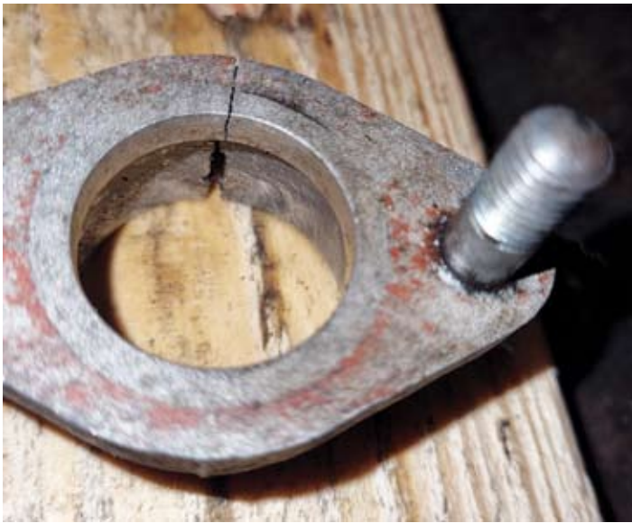
Riss im Ansaugstutzen
