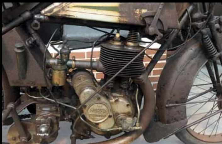
Hier im Bild der Horex T5 Motor mit 500cc...
